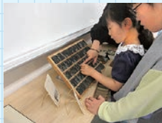
1 まずは、たくさんある文字の中から、使う文字の「活字」を選んで…
